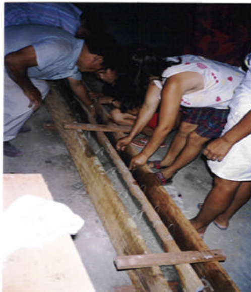
Retiro del molde para secado de la bloqueta
